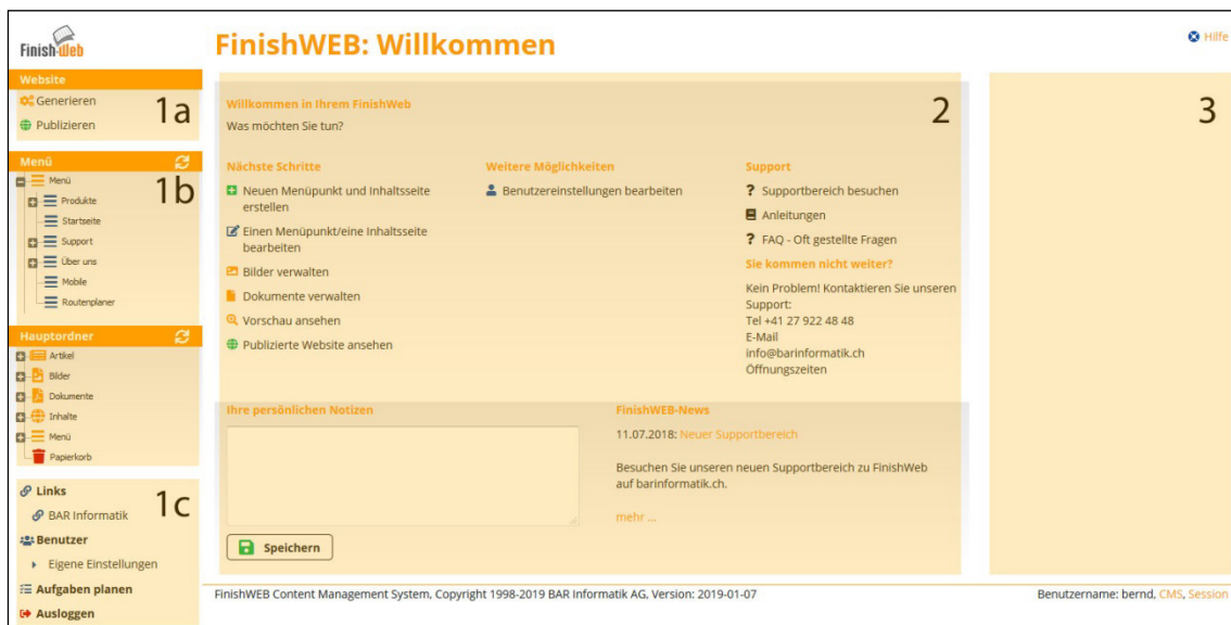
Abbildung 2: Oberfläche von FinishWeb mit drei verschiedenen Bereichen: Funktionsauswahl (1), Bearbeitungsbereich (2) und entsprechender Befehlsauswahl (3). Letztere ist im Startbildschirm leer.
